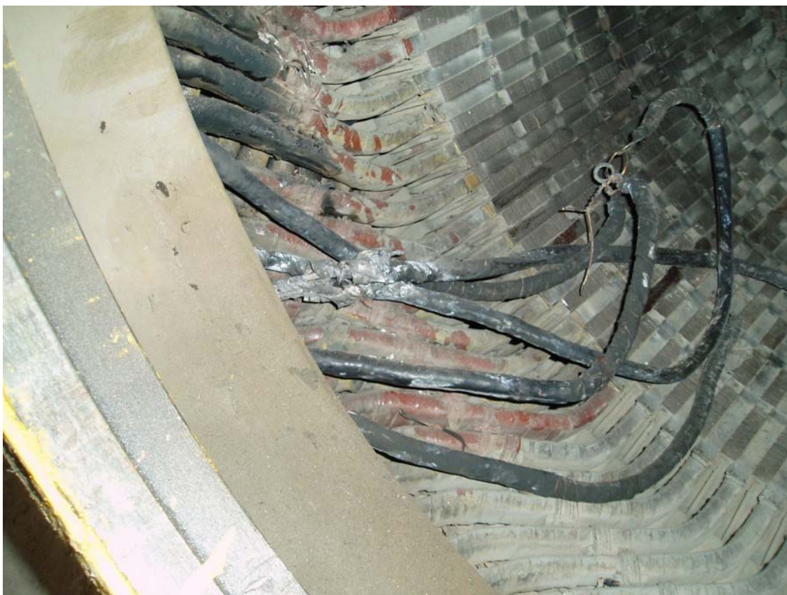
Рис.3 Статор сгоревшего электродвигателя 630 кВт в результате ОДЗ
