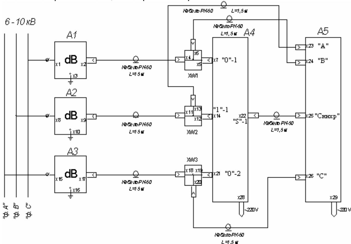
A1, A2, A3 – высоковольтные делители напряжения с постоянным коэффициентом деления XW1, XW2, XW3 – разветвители Т-образные на 3 штекера СР – 50 (GB - 166).
