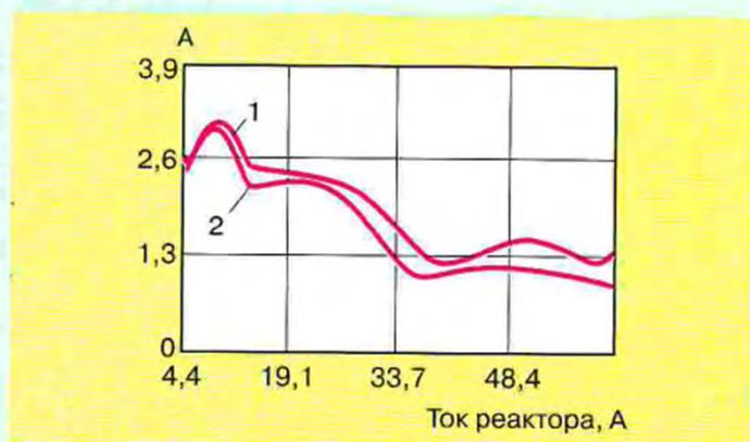
**Рис. 1. Нелинейные искажения тока дугогасящего реактора РУОМ-480**
