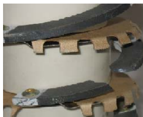
Рис. 2. Дефект резистора, распределяющего напряжения по блокам искровых промежутков
