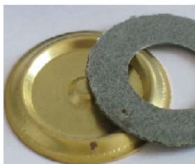
Рис. 1. Вид пробитой прокладки из слюды
