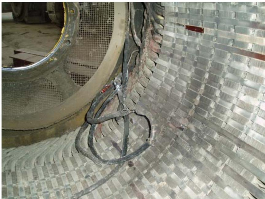
Рис.3 Сгоревший статор электродвигателя СТД-630 в результате ОЗЗ
