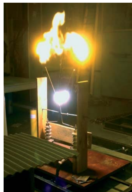
Рис. 2. Дуговой промежуток при токе ОДЗ 45 А
