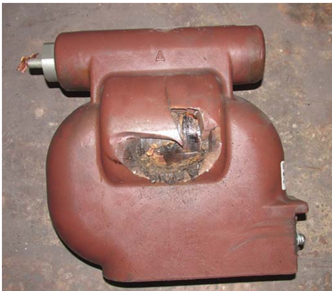
Рис. 1. Повреждение с перегоранием первичной обмотки и разломом корпуса ТН 10 кВ с литой изоляцией
