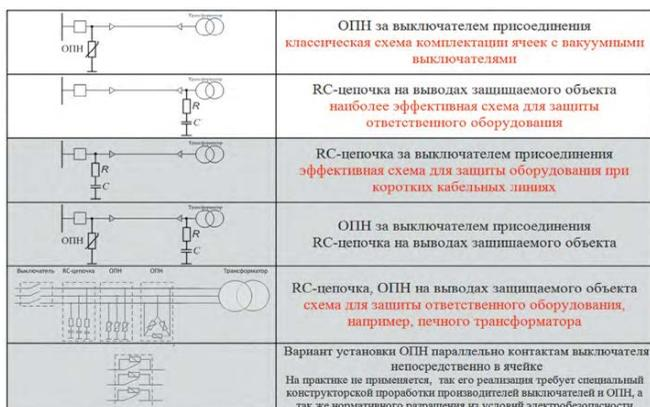
Рис. 10. Основные схемы защиты изоляции трансформаторов от коммутационных перенапряжений
