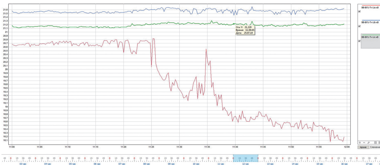
Рис. 10. Характерная диаграмма снижения напряжения по одной фазе из-за предаварийного состояния ТН
