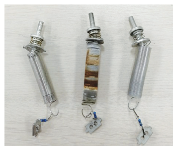
Рис. 8. Состояние контактных пружин в разобранных ПУ для ТН, находившихся в эксплуатации более 3 лет
