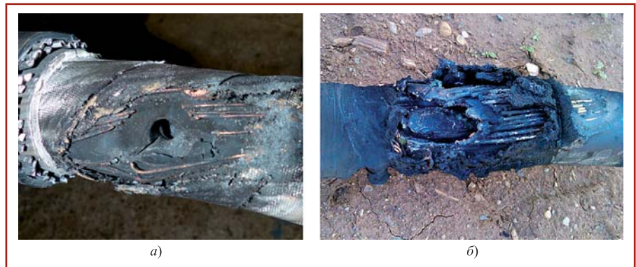
Рис. 2. Результат термического воздействия однофазной заземляющей дуги в кабеле при отключении повреждения за время до 10 с (а) и удержании его до 1 мин (б)
