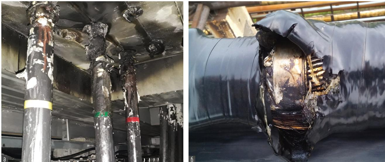
Обозначения: а) при развитии ОЗЗ в КЗ; б) отказ в муфте при отключении «земли» за время до 1,5 с.
