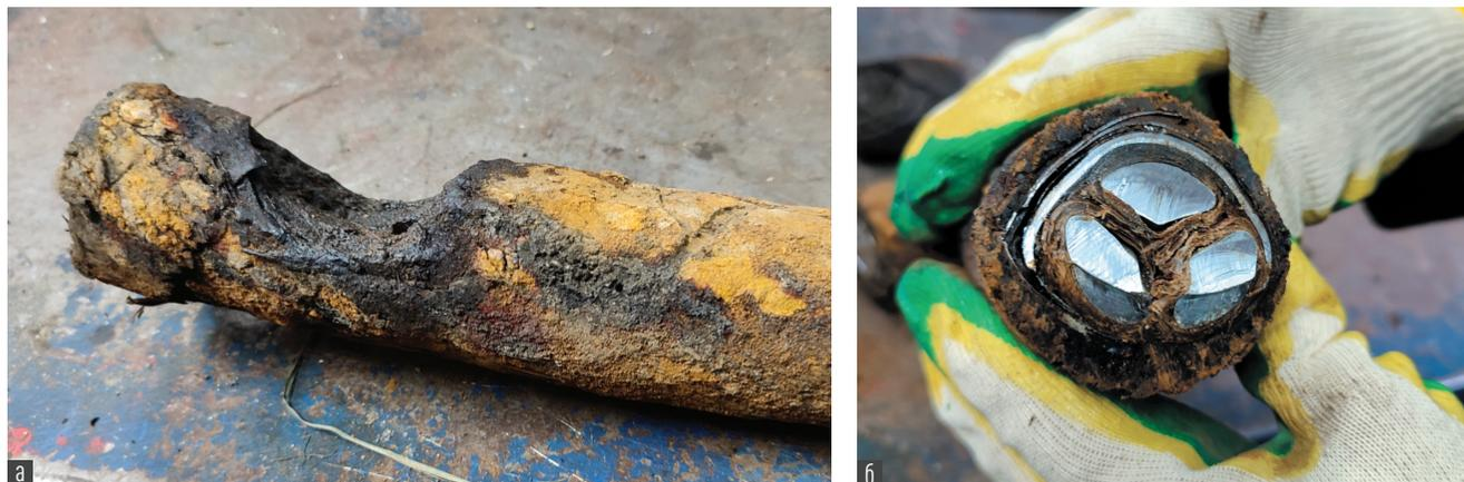
Обозначения: а) частичное выгорание фазной жилы; б) стекание масла — осушение изоляции.
