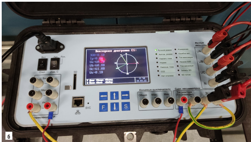
Рис. 3. Подключение прибора ИПС во вторичные цепи трансформатора напряжения (а) и лицевая панель устройства (б)
