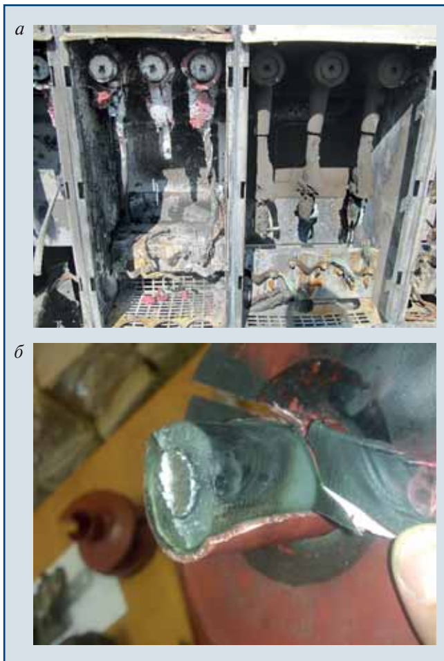
▲ Рис. 4. Масштаб повреждения при удержании (а) и быстром отключении (б) однофазного замыкания в сети с СПЭ-кабелями
